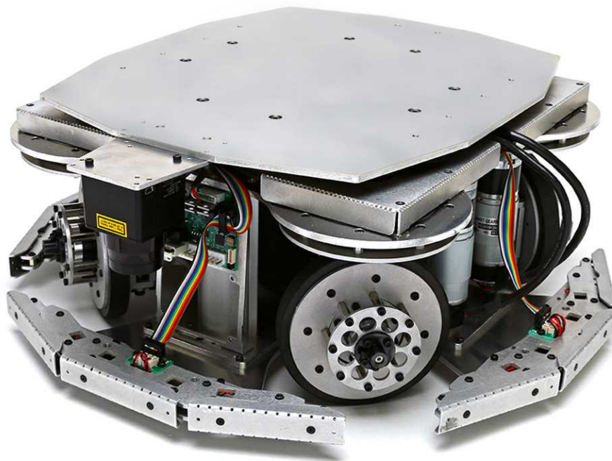
4WDS ローバーVer2.1(バンパーセンサーおよび LRF オプション搭載時)
