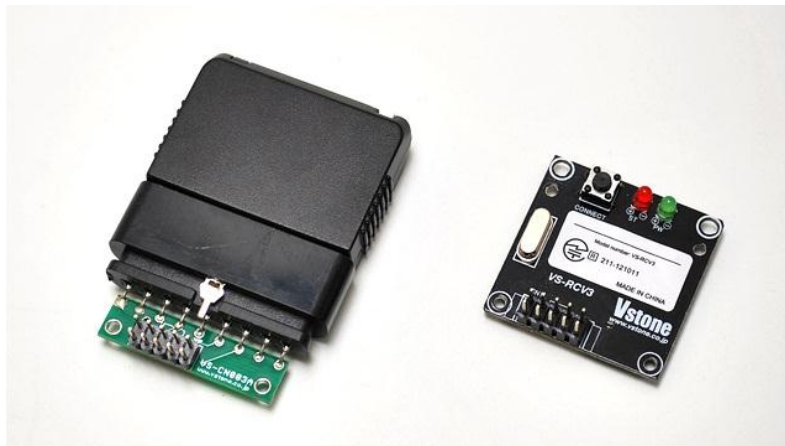
(左) 従来品 60.5 x 43.5 x 12.5mm (右) 新製品 35.0 x 35.0 x 8.0mm
