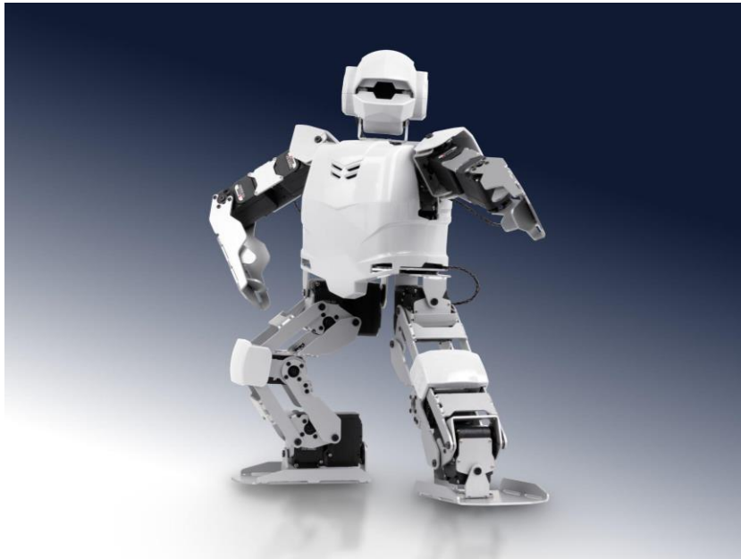
多数のサーボモーターを搭載し、さまざまなポージングが可能
